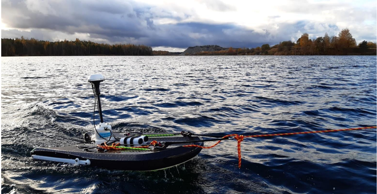
Foto 2.1.11. Vaade Rummu tehisjärvele. Taamal paistab lubjakivitööstuse jääkidest kuhjatud mägi. Esiplaanil on sügavusmõõdistusteks kasutatav sonar Hydrosurveyor M9 .
